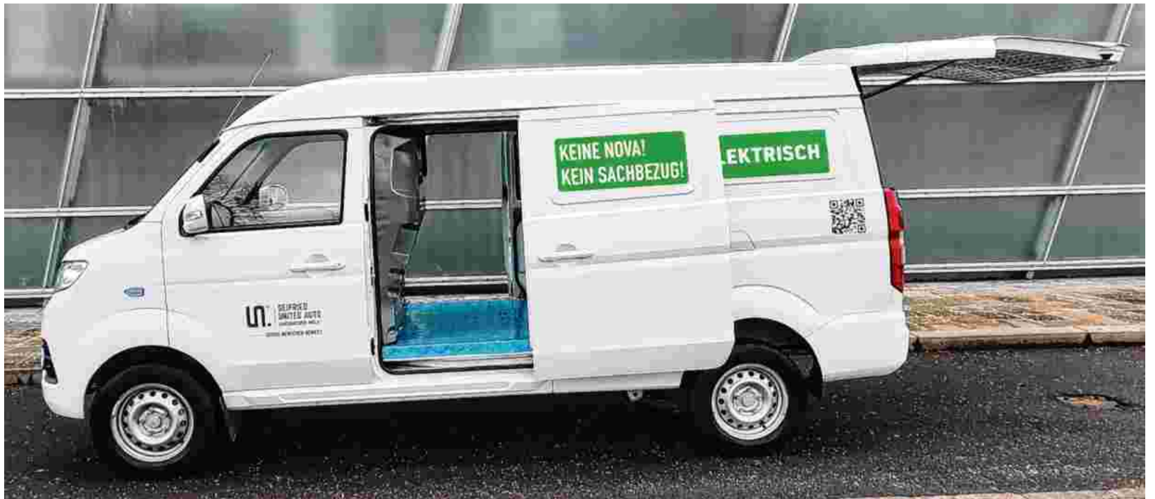
NME Cargo Van: Die beiden seitlichen Schiebetüren sind serienmäßig – und der Laderaum hat ein maximales Volumen von fünf Kubikmetern.
